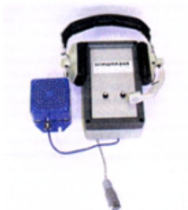
7 Sprechstation der Sprechanlage (Fotos: Schwarzer GmbH)
