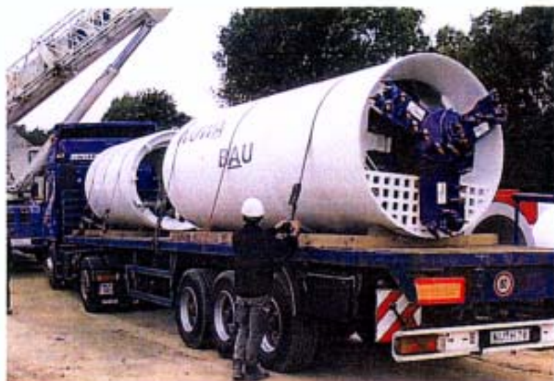
3 Vortriebsmaschine (Vollschnitt) für Vortrieb DN 1400
