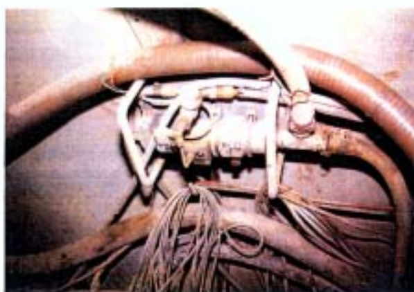
5 Bentonitventil. Die automatische Bentonitsteuerung gewährleistet ein kontinuierliches und sicheres Schmieren der Rohrleitung, unabhängig vom Durchmesser und der Haltungslänge des Rohrstranges
