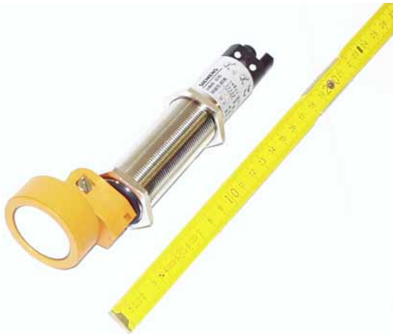
Abbildung des Ultraschallsensors mit Größenvergleich
